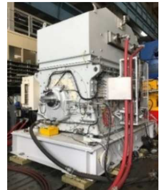
Fig.21. Rotor + Skid on rigid soleplates.
