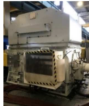
Fig.20. Motor on rigid soleplates.
